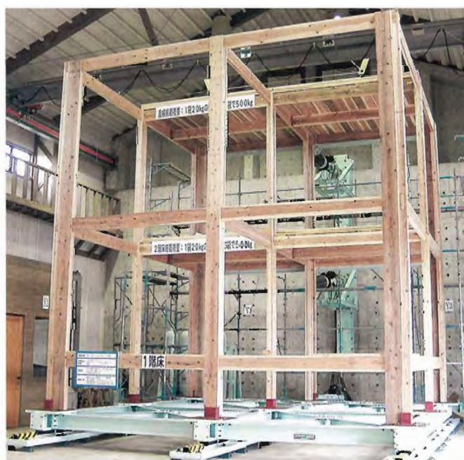
試作した軸組構造体の全体写真
