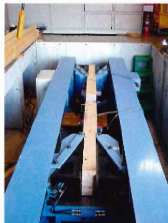
引張り試験の状況
