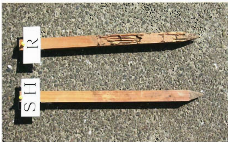
シロアリ食害度評価時の杭の様子 (食害度評価例：SH = 0、R = 3)
