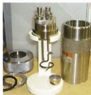
図2 ボンベ式熱量計のステンレス 製耐圧容器
