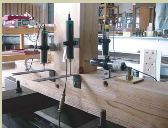
写真2 小根ほぞ差し試験体曲げ試験
