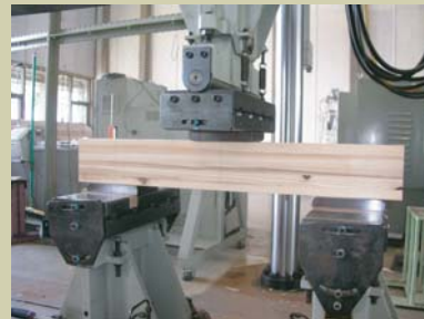
図3 せん断試験(3点曲げISO方式)
