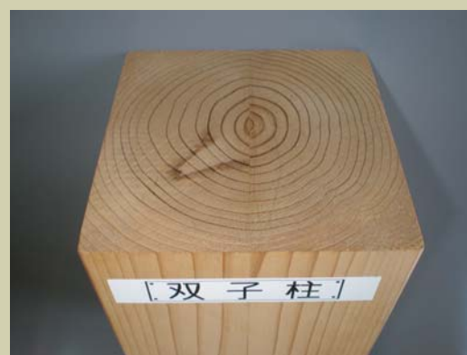
写真2 2ピースの積層柱の断面 (6cm厚のラミナを2枚装着したもの)
