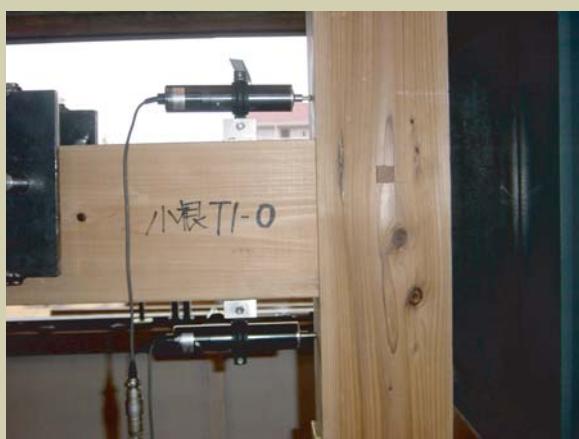
写真1 小根ほぞ差し試験体引張試験
