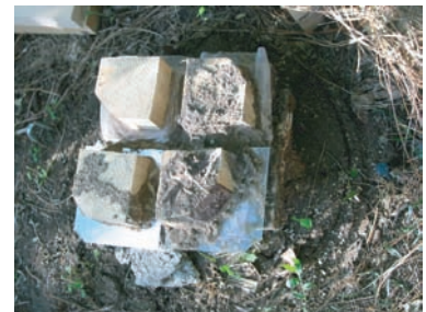
図2 種々の材質で作ったサンドイッチ型バリアーの設置後2年の様子
