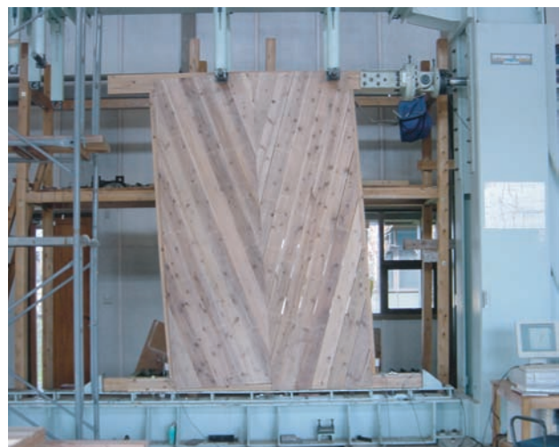
写真2 斜め貼り壁試験状況
