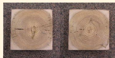
図4 内部割れの様子(90min処理)
