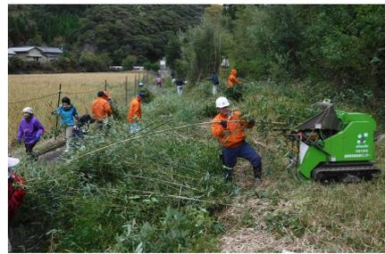
写真5 伐採した竹は専用の小型粉碎機で処理
