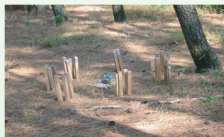
写真1 シロアリ試験杭の設置状況
