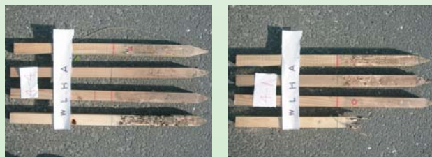
写真2 シロアリ食害判定時の杭の様子
