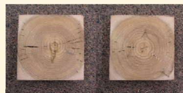
図4 内部割れの様子(90min処理)
