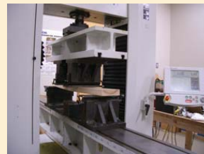
ラミナ試験風景 (左：曲げ，中央：縦引張，右：縦圧縮)
