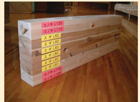
開発した異樹種集成材の外観 (10プライ集成材)
