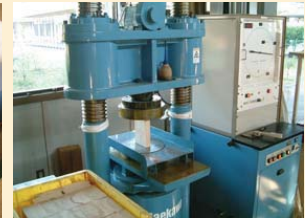
ラミナ試験風景 (左：曲げ，中央：縦引張，右：縦圧縮)
