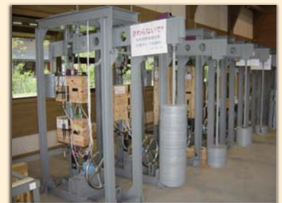
写真 3 接合部の引張短期試験・クリープ試験の様子
