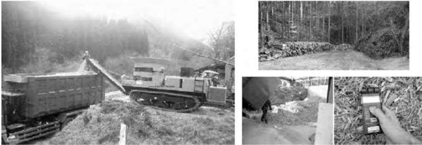
移動式破砕機とフックロール車を使用した収集運搬 木質チップの低含水率化に向けた簡易試験
