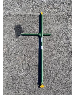
蓋開閉用の専用工具
