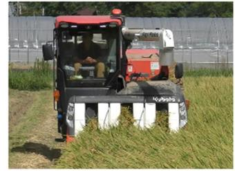
ロボットコンバインによる収穫作業
