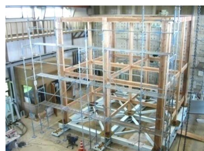
軸組構造体の水平加力試験
