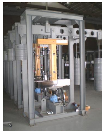
柱脚柱頭接合部クリープ試験
