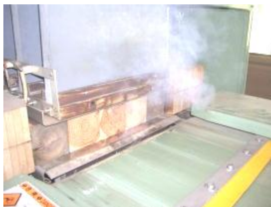
スギ心持ち柱材のホットプレスによる 表面割れ抑制処理
