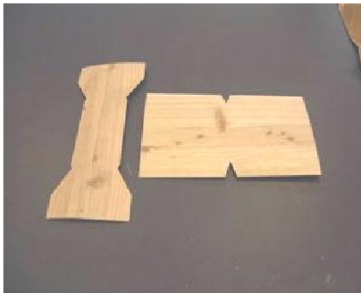
深底容器製造前の単板（左図）と製品（右図）
