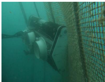
ロボットによる網洗浄（船上操作）
