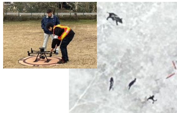
サーモカメラ付きドローンと 上空から撮影した画像
