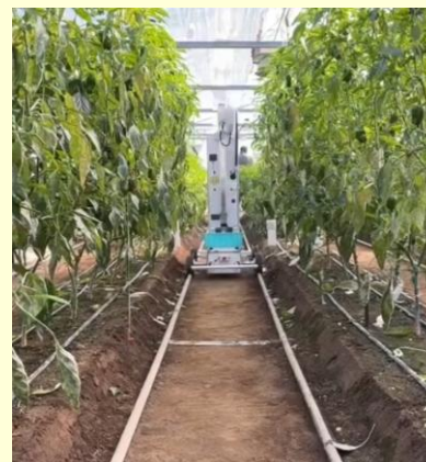
〈ピーマン自動収穫ロボット〉
