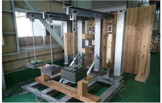
5-(1) LSB接合部の長期性能評価の移転(試験の様子)
