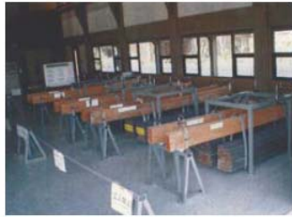
曲げクリープ試験の様子
