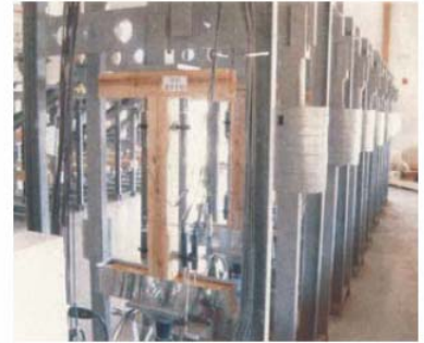
めり込みクリープ試験の様子
