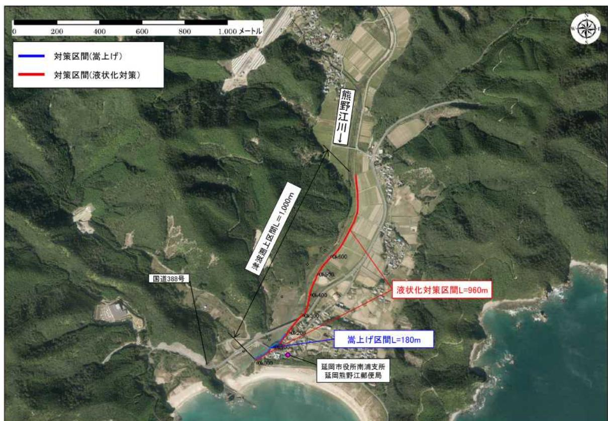
図 4-1 熊野江川施工区間図
