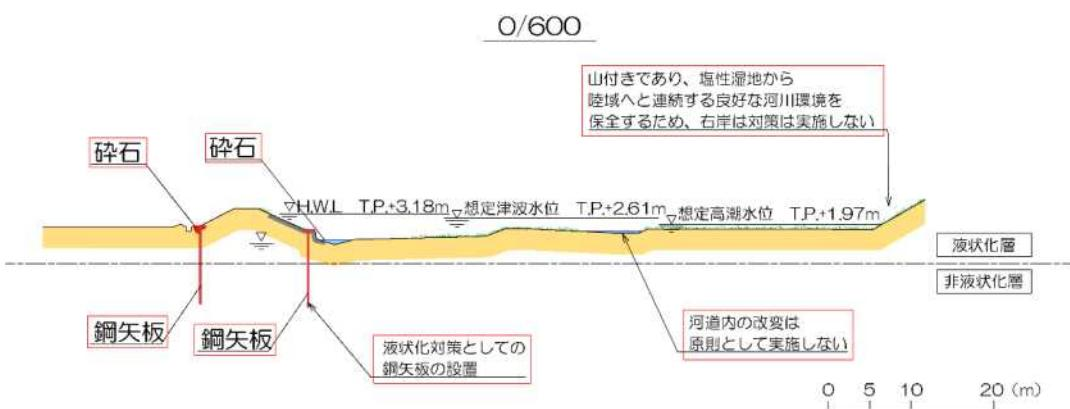
図 4-2 熊野江川河道改修断面図
