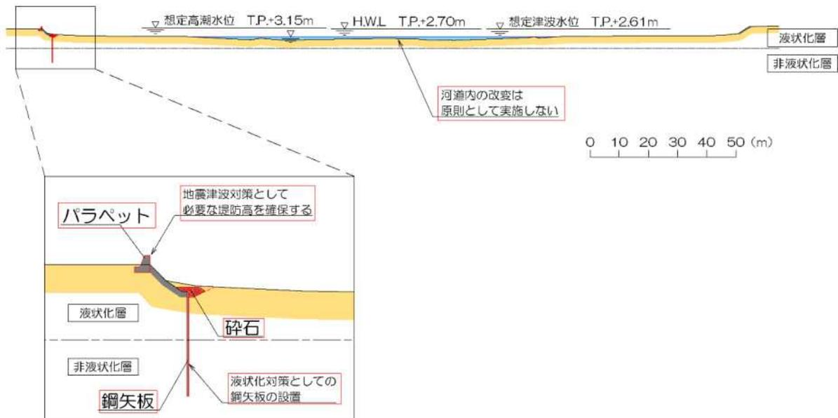
図 4-2 塩見川河道改修断面図
