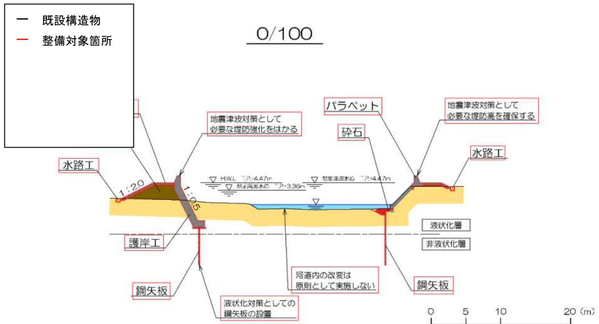
図 4-2 風田川河道改修断面図
