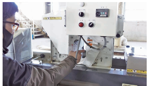
図3 高密度苗の播種機を調整する年前課長補佐
