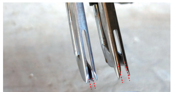
図4 田植え機の爪先(左:高密度育苗専用(幅が狭い)右:通常)
