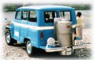
ガス発生炉を積んだ 木炭自動車
