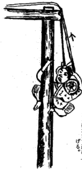
① 綱のかけ方 横木の端と綱をかけるには、引手がある横木の端をかける方がよい。
