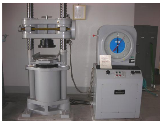
コンクリート圧縮試験機（2,000 k N）
