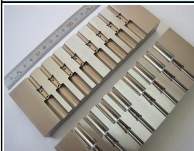
全切削加工で仕上げられた、 16個取金型のキャビティ
