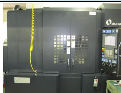
4軸同時制御加工が可能な、 高速高精度マシニングセンタ
