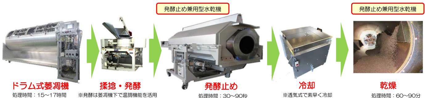
図1 開発した発酵止め兼用型水乾燥機による紅茶製造方法
