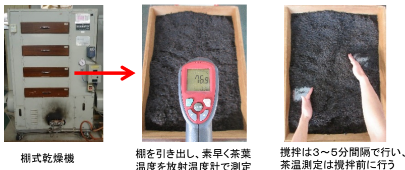
図1 発酵止め処理における茶温測定方法
