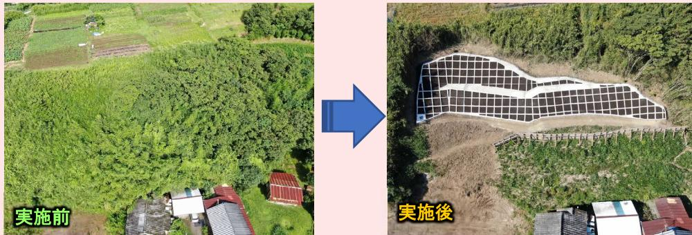
【宮崎県】岩崎－1地区（日向市）において、急傾斜地の崩壊による土砂災害を防止するため、急傾斜地崩壊対策施設に整備に取り組んでいる。
