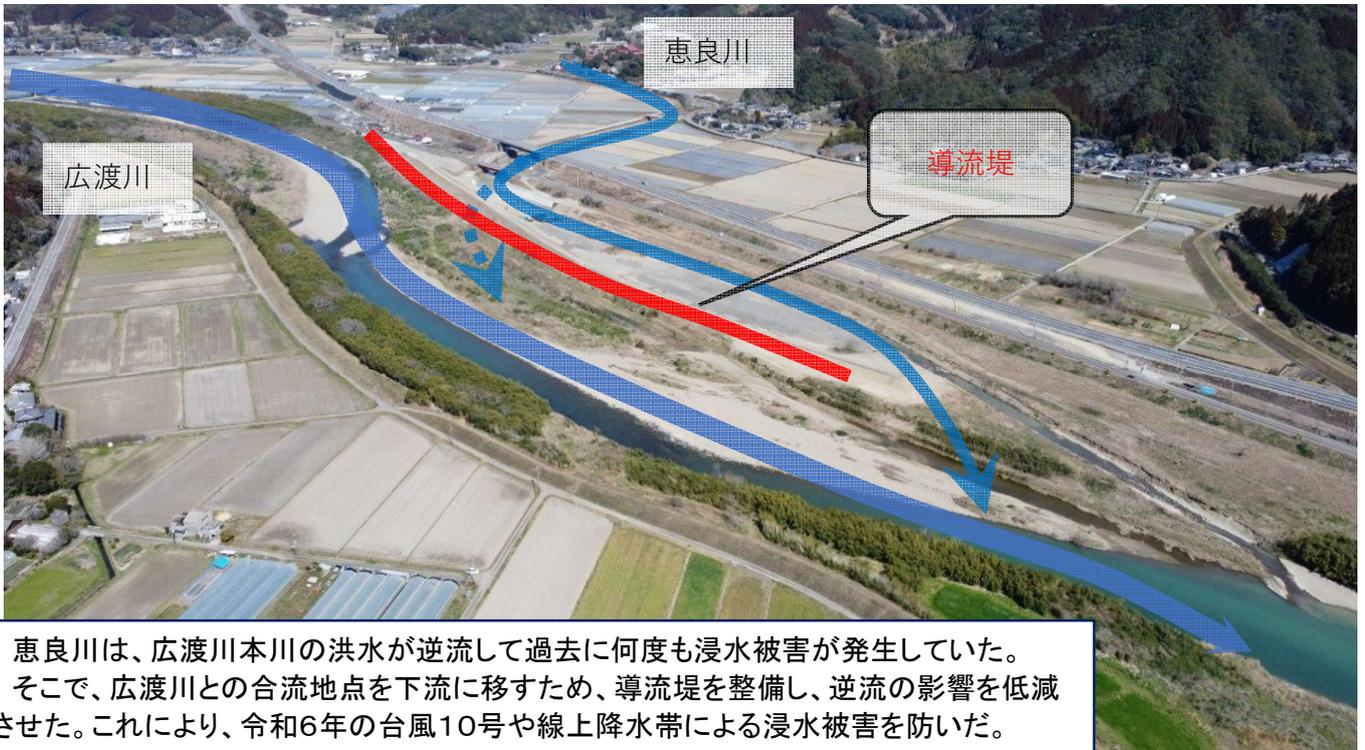
恵良川は、広渡川本川の洪水が逆流して過去に何度も浸水被害が発生していた。そこで、広渡川との合流地点を下流に移すため、導流堤を整備し、逆流の影響を低減させた。これにより、令和6年の台風10号や線上降水帯による浸水被害を防いだ。
