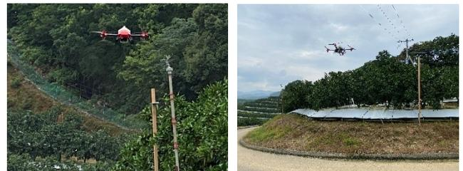
写真1：ドローンによる農薬散布
