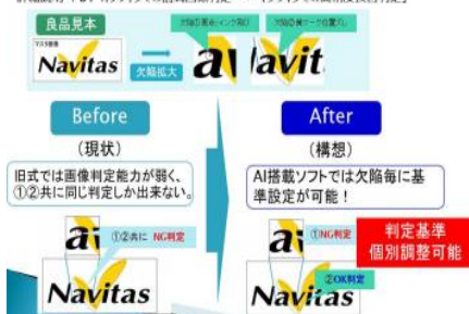
I. 印刷機の品質確認・検出作業のスキルレス化&省人化 詳細説明「b. オフラインでの目式画像判定 → インラインでの高精度良否判定」
