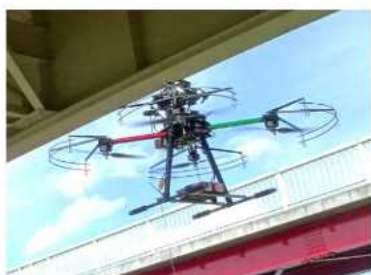
▲橋梁の損傷写真を 撮影する技術
