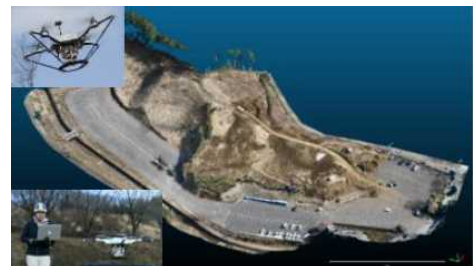
（ドローン等による3次元測量）
