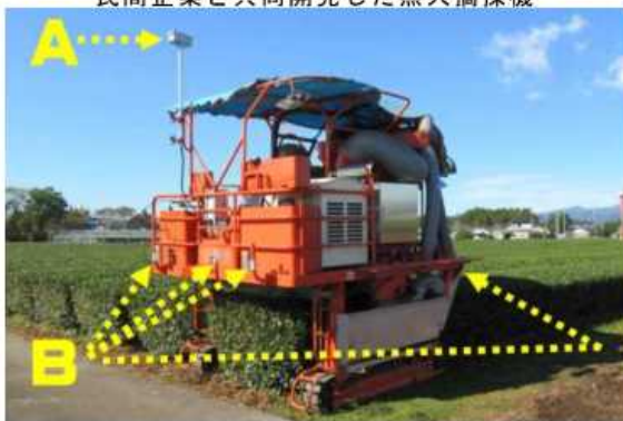
実証試験中の吸引式無人防除機 (A: 方位センサー、B: 超音波センサー)
