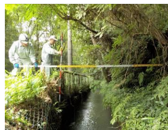
水路周囲の寸法測定
