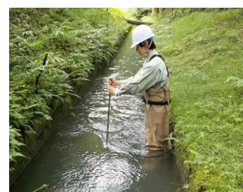
水路の流速測定
