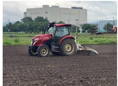
図3 GPSレベラーによる整地作業
