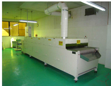
遠赤外線照射椎茸殺虫・成分増量装置 (椎茸の殺虫・成分の増量を行う)
