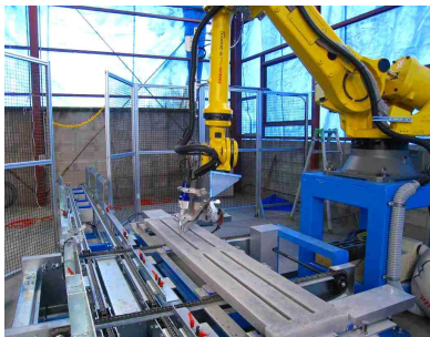
バリ取り機械 (コンクリート製品の縁の面取り仕上げを行う)
