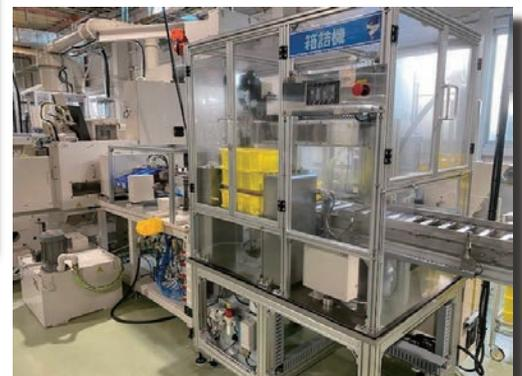
搬送付帯装置による自動化
