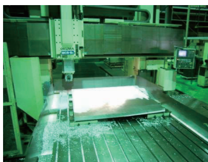
大型五面加工機による 製缶加工 アルミプレート加工
