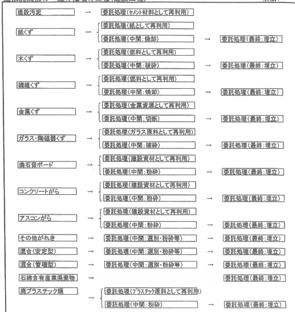
産業廃棄物の一連の処理の工程(建設工程)
