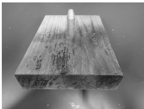
図3 設置後479日目の試験体 (繊維平行方向)
