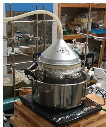
図1. 試作蒸留装置
