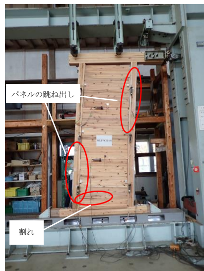
図 2 MLT3CⅢ-H 試験体の終局状態
