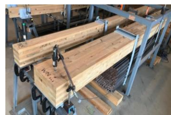
図2「テープなし」試験体の試験風景
