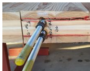
(i) CLT の割裂破壊および積層接着面の破壊
