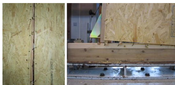
(左) Aタイプ パンチングアウト、たて枠の割れ (右) Bタイプ 釘引き抜け、パンチングアウト、たて枠引き抜け
