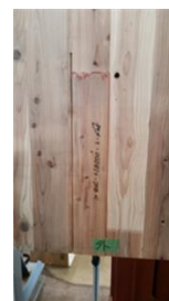
(ii) CLT 最外層ラミナの破断
