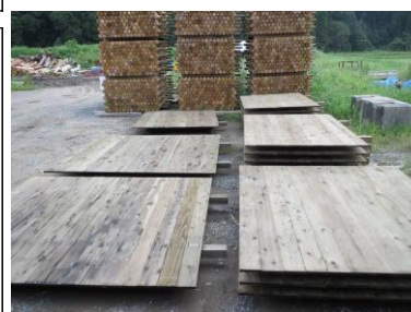
写真1 法面パネル試作
