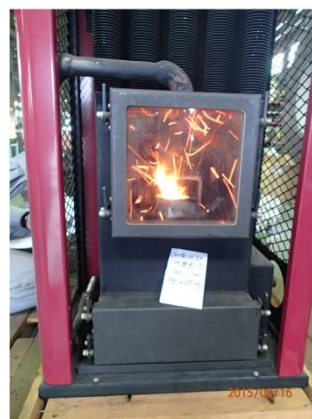
図3 ペレットストーブでの燃焼試験
