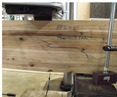
写真2 材中央部のせん断破壊 (補強用木ネジ2本)
