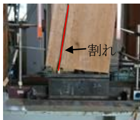
写真3 柱の割れを伴う柱脚接合部の破壊
