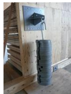
写真1 吊り荷重試験
