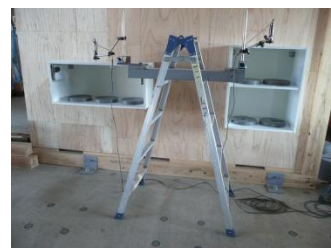
写真2 固定強度試験
