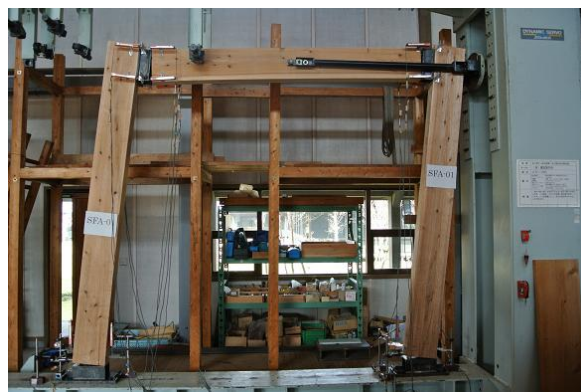
写真2 試験体の終局状態
