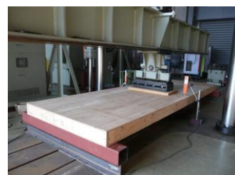
写真3 パネル曲げ試験
