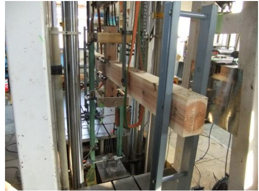
図2 試験方法(対称純曲げ試験)
