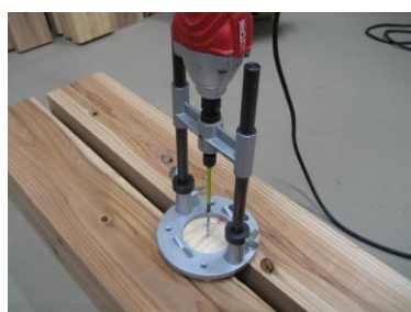
図2 ガイドを用いたねじの打ち込み
