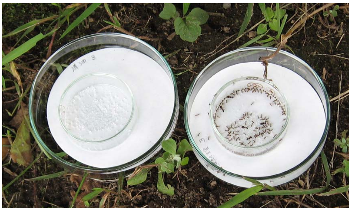
図3 スギ精油のアリ忌避効果確認試験（左：精油有り、右：精油無し）
