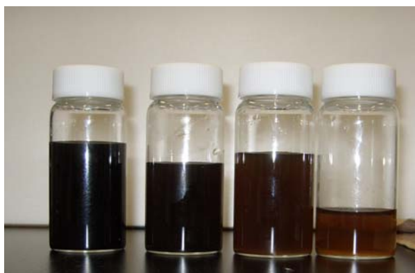
図 3 オゾンによる脱色効果 （左から、原液、1 時間、2 時間、3 時間処理）
