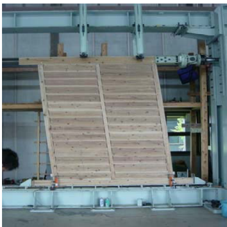
写真1 横貼り壁試験状況
