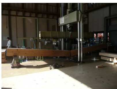
写真 1 曲げ破壊の状況
