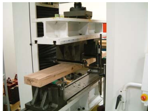
図 2 曲げ試験風景
