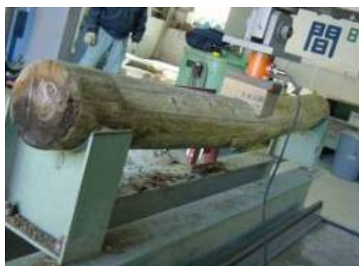
写真 4 ビームの曲げ試験
