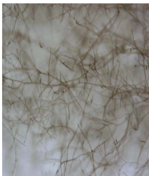
図 4 ドレーン中に繁殖したミズカビ
