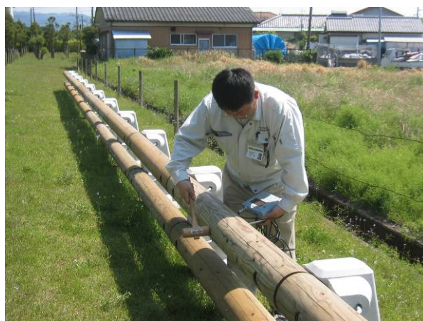
図2 たわみ振動の測定状況
