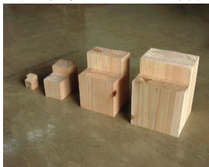
図1 ブロックせん断試験体 左からES25, ES50, ES90, ES110
