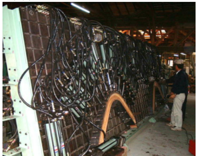
写真 湾曲集成材製造用プレス
