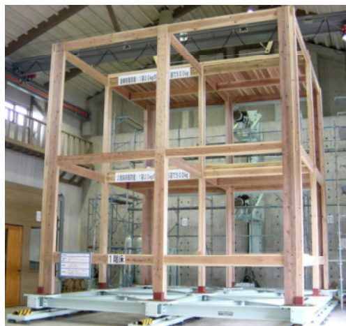
写真 試作した軸組構造体の全体写真
